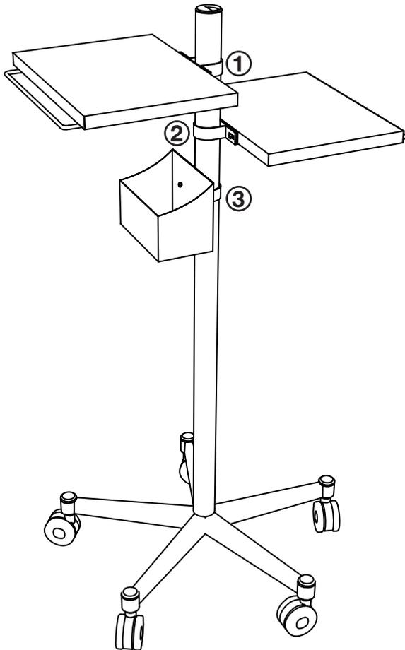
Cada bandeja tiene su sistema de abrazadera para poder ajustar altura de estas.
