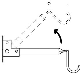
Cuando el soporte no está siendo utilizado puede plegarse hacia la muralla. Para lograr esto se debe sacar el pasador metálico que bloquea el brazo y reubicarlo en la posición plegada.
