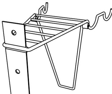
Figura que muestra como debe ir puesto el soporte en la placa muro.
