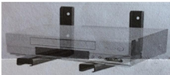
Una vez instaladas las escuadras, regule profundidad entre 20 y 30 cms. según el equipo que vaya a instalar. Considere dejar un espacio posterior para las conexiones. Apriete los pernos laterales para fijar la corredera en la profundidad deseada. Coloque el equipo encima del soporte y realice las conexiones necesarias.
