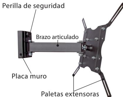
Instale placa a muro, utilizando la llave punta corona o la chicharra. Apriete los tirafondos con firmeza, pero no en exceso, ya que esto podría resultar en la rotura de los mismos.
