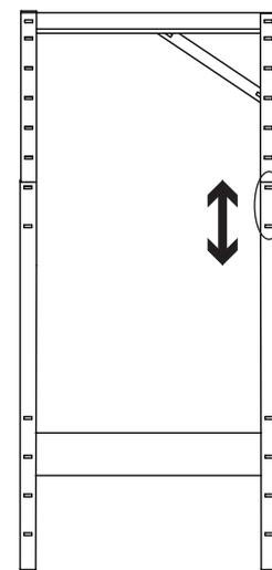
Para regular altura siempre apertar par de perforaciones de patas inferiores en dos de las patas superiores.
