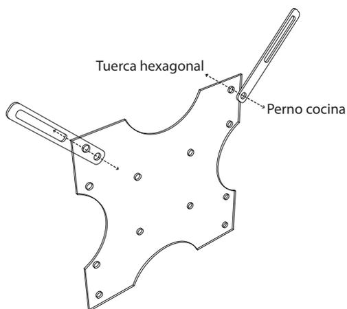
Mediante un encaje el soporte queda asegurado
