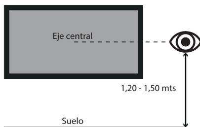
① Presente placa en el muro, en el sentido de las flechas hacia arriba, a una altura recomendada, desde piso a eje central de la pantalla entre 1,20 a 1,50 mts. Luego, nivele y marque 6 perforaciones.
